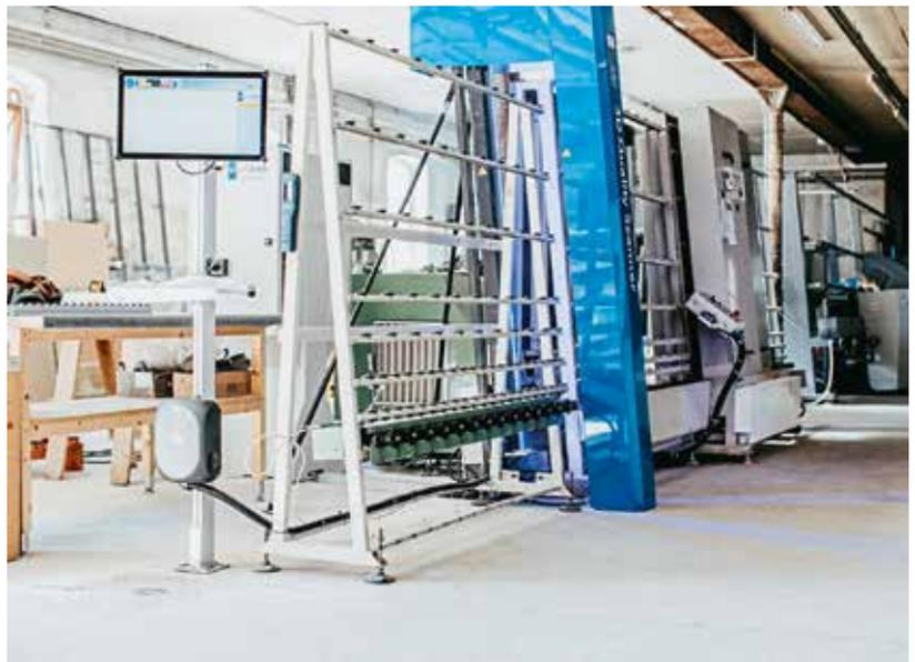
Die Mitarbeiter beim handwerklichen Spiegelhersteller Spiegel Art kombinieren digitale und maschinelle Hilfen wie den Glas-Scanner mit ihren eigenen Fähigkeiten.
